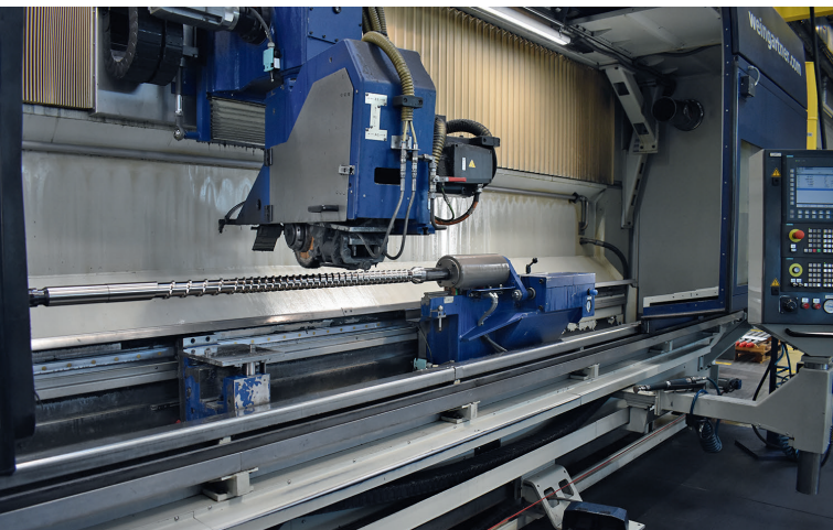
6 Bestandteil des Fertigungssystems: Weingärtner-Bandpoliermaschine für die Feinbearbeitung © Weingärtner
