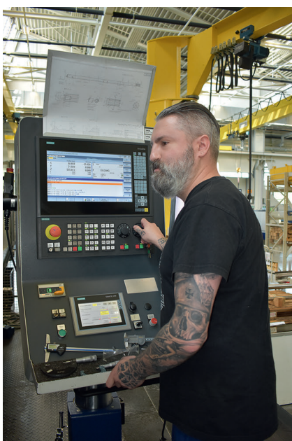
3 Als CNC trägt die Pick Up 400 eine Siemens Sinumerik 840D sl © Weingärtner
